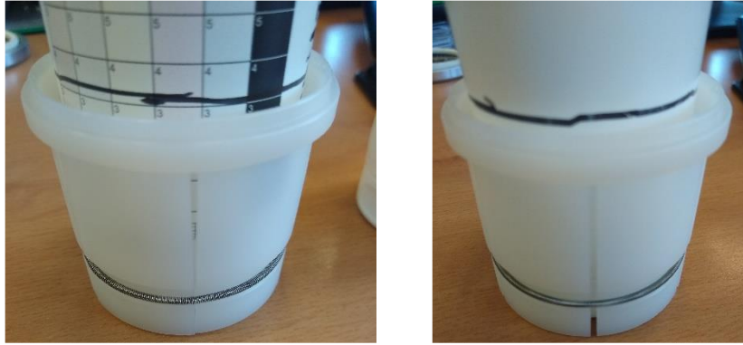
Différences d'introduction des tubes dues aux différences de hauteur des bouchons
