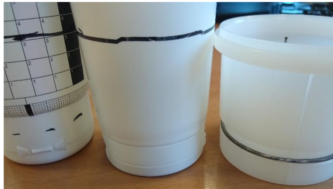
(GAUCHE) Ajustement sur le bouchon, dans un tube standard (CENTRE) Ajustement sur la jupe, dans un tube avec un bouchon de profil bas
